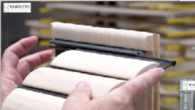
installeer de binnenflap in het paneel
